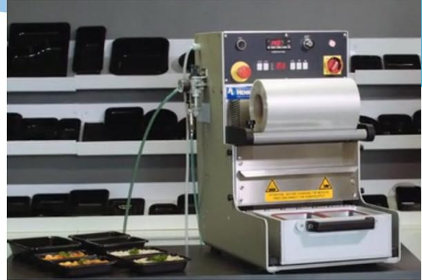
Les moules se changent facilement sans outils, rendant la machine compatible avec plusieurs sortes de barquettes et pellicules. Le détecteur de pression à l'intérieur des barquettes est sous contrôle numérique afin de garantir une meilleure durée de vie des produits, ainsi que le temps de scellage le plus efficace possible.
